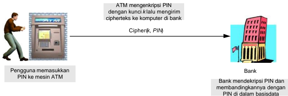
Gambar 14.3 Mekanisme enkripsi dan dekripsi PIN pada transaksi dengan mesin ATM
